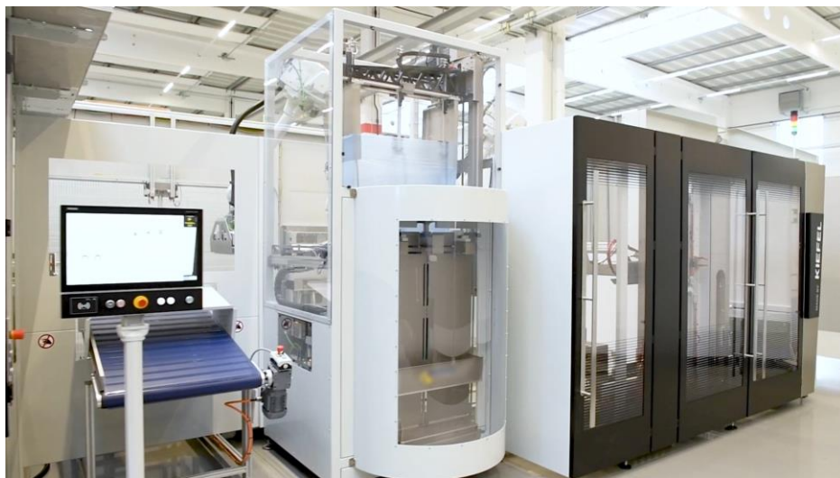
Module der KSA, wie hier der Beuteinleger oder Kartonverschließer, können an bestehende sowie neue KMD-Maschinen angeschlossen werden. © KIEFEL GmbH
