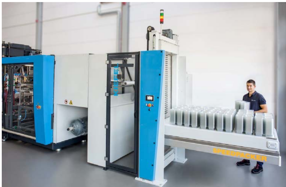
BU: SpeedPacker - Puffer- und Entnahmestation für KMD Speedformer Serie
